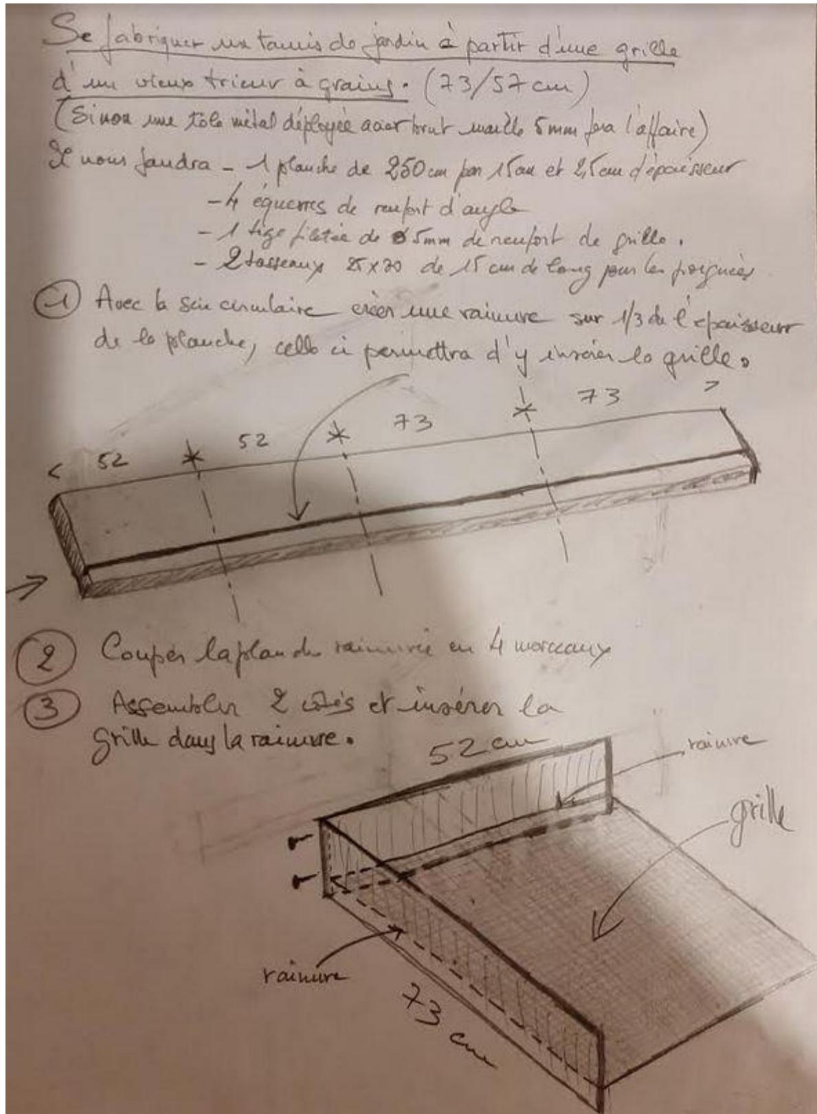
(4) Assembler les 2 autres côtés et les positionner sur les 2 côtés déjà fait afin de bloquer la grille sur les 4 côtés.
